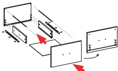
Fixe as corredeiras telescópicas nas marcações laterais da gaveta utilizando o parafuso **4x14 I**
