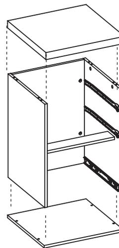
**2.2** Posicione o tampo e a base e fixe utilizando uma chave Philips ou Allen para a base
